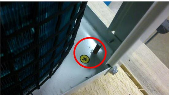
Figure 9 : Connexion de mise à la terre sur la plateforme du groupe
